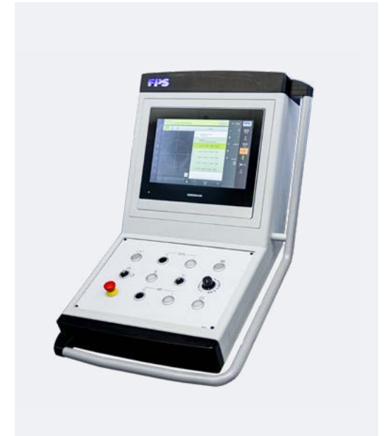
Heidenhain Positip 8016 Positionswertanzeige, Dialoge, Eingaben und grafische Funktionen. Werkzeugspeicher, Restwegbetrieb mit Eingabe der Sollposition in Absolut- oder Kettenmaß.
