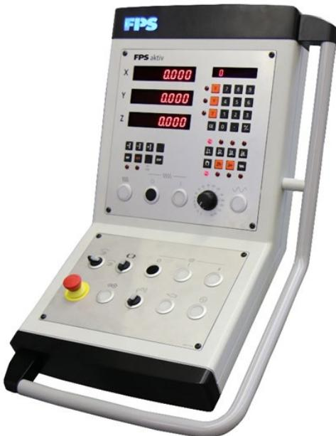
Einfach zu bedienende FPS AKTIV 3 Achsen Digitalanzeige mit der Möglichkeit zum aktiven automatischen Positionieren:
