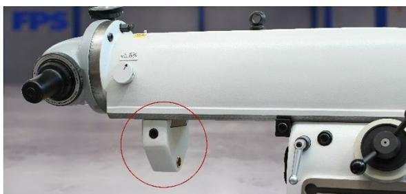
Der verschiebbare Fräskopfarm kann als Gegenhalterarm für das Gegenlager verwendet werden.
